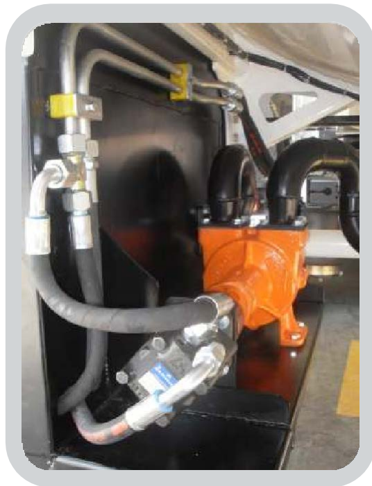
Гидравлический двигатель и топливный насос. На заднем плане корпус счётчика.
